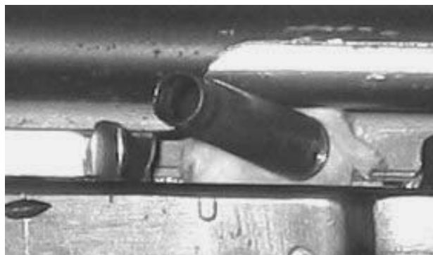
Положај испаљене чахуре приликом избацивања из АП марке “Црвена Застава” М70АБ2, серијског броја 589375, cal. 7.62x39 мм Слика бр. 8
