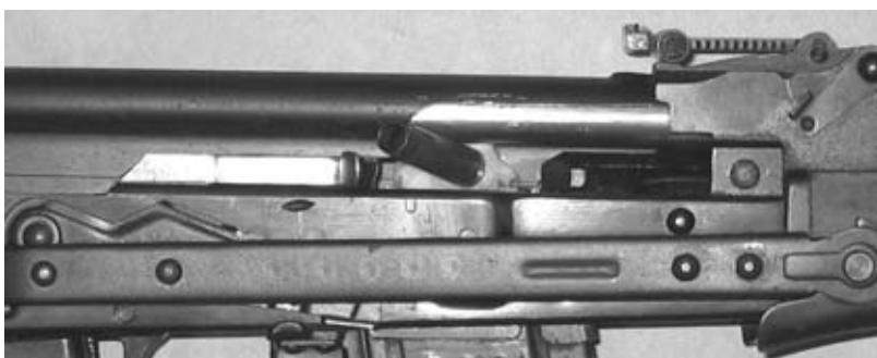
Положај испаљене чахуре приликом избацивања из АП марке “Црвена Застава” М70АБ2, серијског броја 589375, cal. 7.62x39 мм Слика бр. 7
